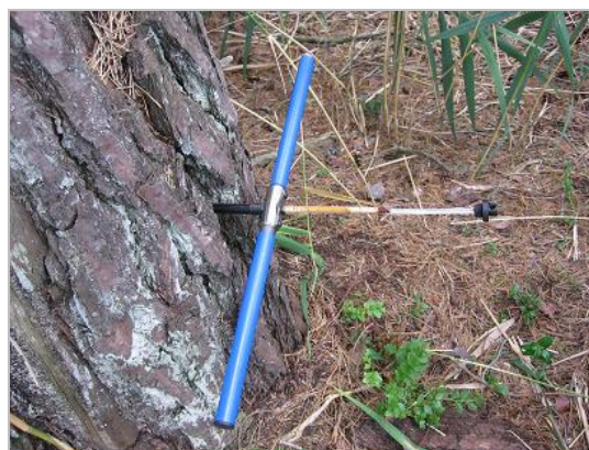
8. attēls. Koksnes urbuma iegūšana ar Preslera svārpstu.
